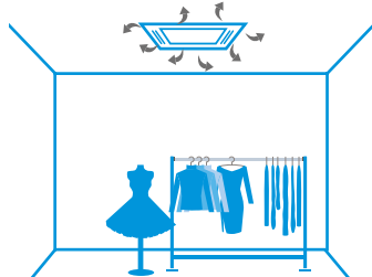
Rozkład powietrza z zabrudzonym filtrem
