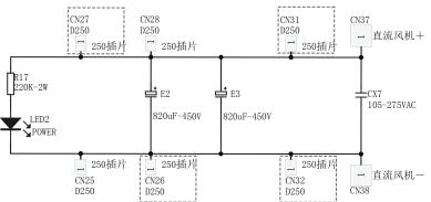
注: CN37 焊接到CN40, CN38 焊接到CN41
