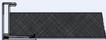
Izolacja cieplna zewnętrzna kauczukiem samoprzylepnym
